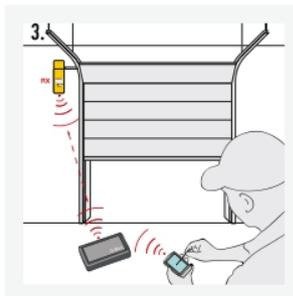
3. Встроенный передатчик в OX1T и OX2T позволяет удаленное подключение для управления кодами.
